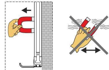
Magnete werden grundsätzlich auf der Oberfläche nicht verschoben, sondern abgehoben und wieder aufgesetzt!
